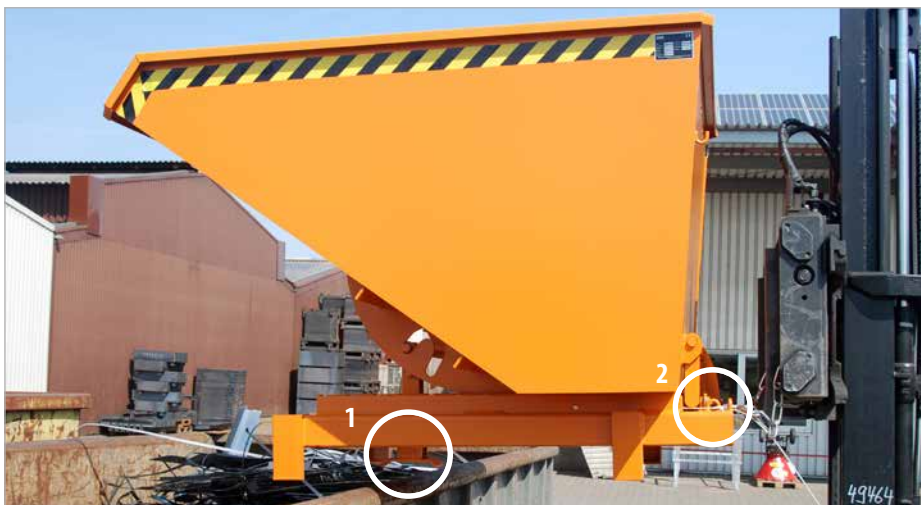
① Automatische Entriegelung
