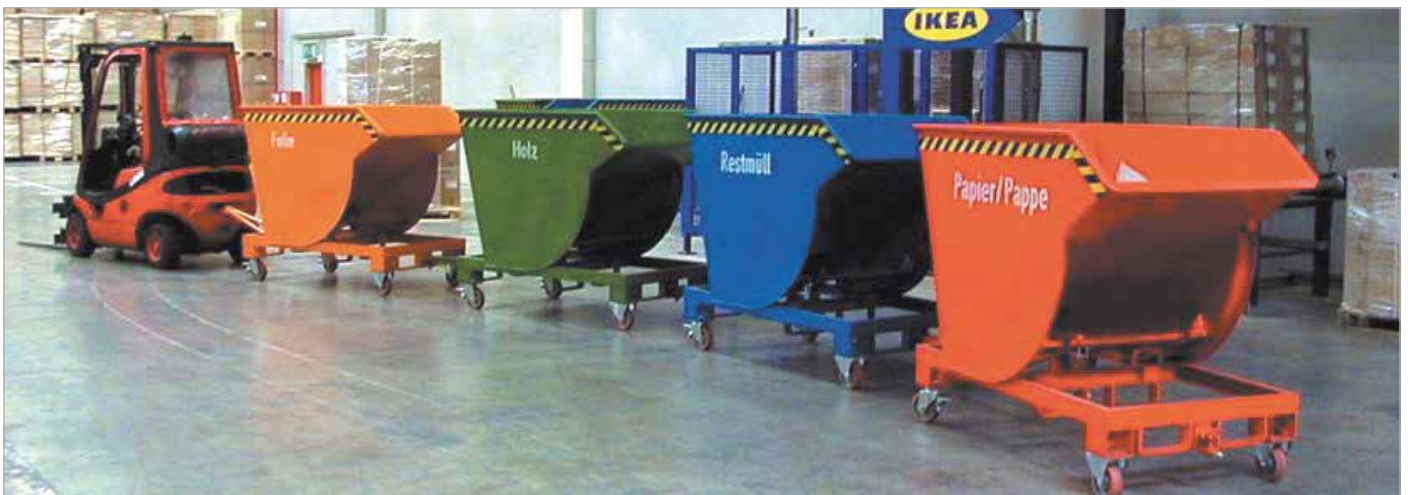
BKM mit Rollen und Anhängervorrichtung mit Deichsel
