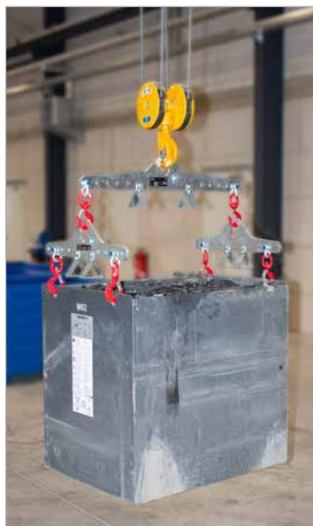
Kombination aus mehreren Traversen zur H-Traverse
