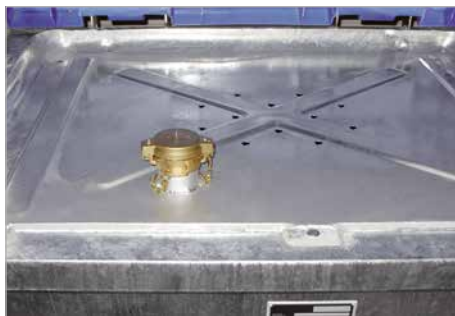
Einlaufwanne und 2" Tankwagenkupplung
