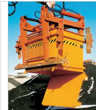
BC mit Steinklammer-Entriegelung
